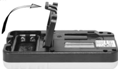
Aprire il coperchio del vano della batteria (16) in direzione della freccia e inserire le batterie nuove in base al simbolo nell'apposito vano.
