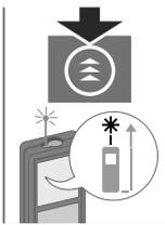
Taste ON 2 sec drücken, um den kontinuierlichen Lasermodus zu aktivieren. Wird 180 sec lang keine Taste gedrückt, schaltet sich das Gerät automatisch aus.
