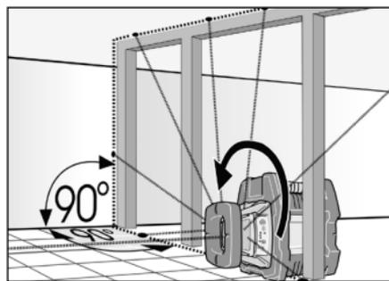
Pose de dalles, de panneaux, de parquets (au sol, au mur, au plafond) ; alignement d'angles droits.
