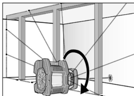
Tracer des plans de référence verticaux, par exemple mesurer des cloisons de séparation.
