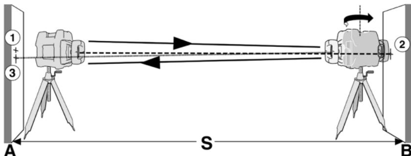
Le contrôle vertical nécessite deux murs parallèles situés à une distance d'au moins 10m.
